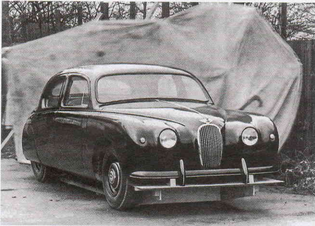
Натурный макет седана Jaguar. Сотрудники компании на вытянутых руках держат позади машины брезент для контраста
