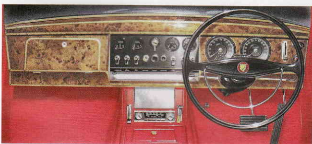
Приборная панель Mk 2 поражала отделкой из массива орехового дерева, тогда как конкуренты подчас предлагали просто крашенный металл
