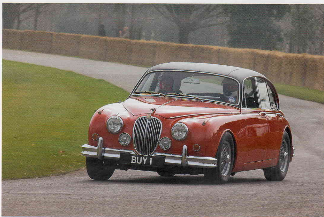
Повороты Jaguar Mk2 проходит с заметным креном. На этом автомобиле установлены задние крылья без щитков, с отбортовкой по вырезу. Такие предпочитали спортсмены
