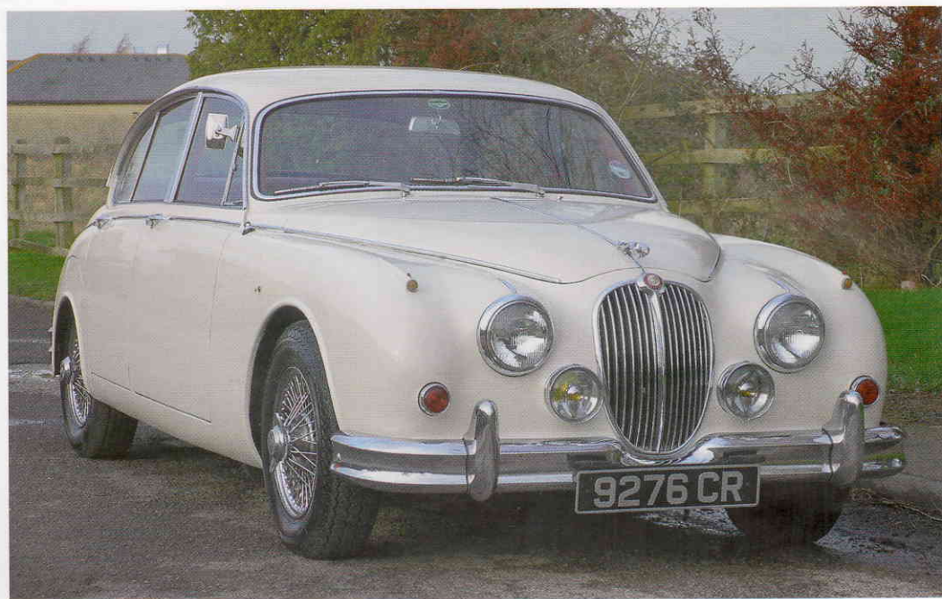
Jaguar Mk2 предлагался на штампованных колесах с креплением на пяти шпильках или на спицованных с креплением центральной барашковой гайкой (на снимке)
