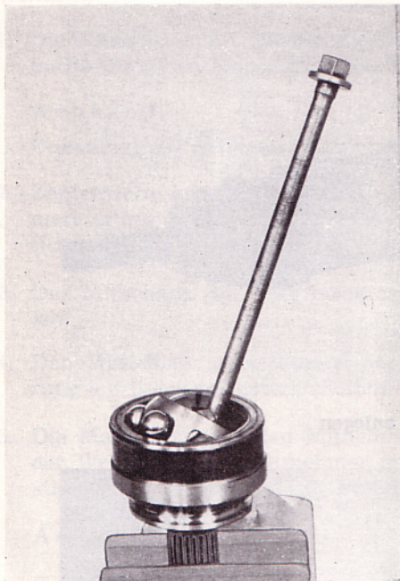
Bild F 21. Demontage des Gelenkes
