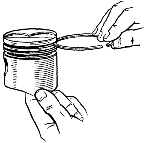
Рис. 45. Проверка перемещения поршневого кольца в канавке поршня
