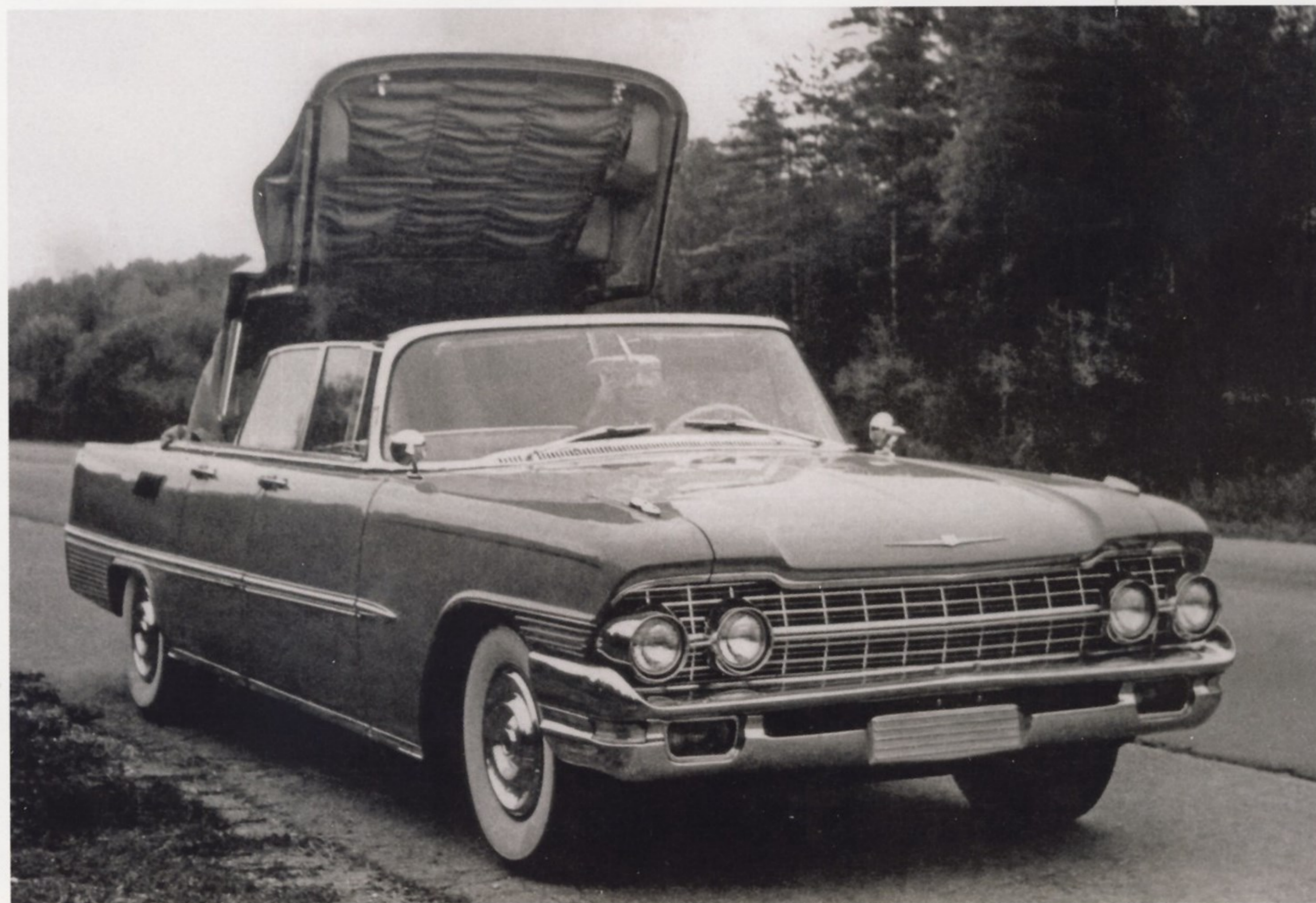
Демонстрация механизма раскладывания мягкого верха машины
