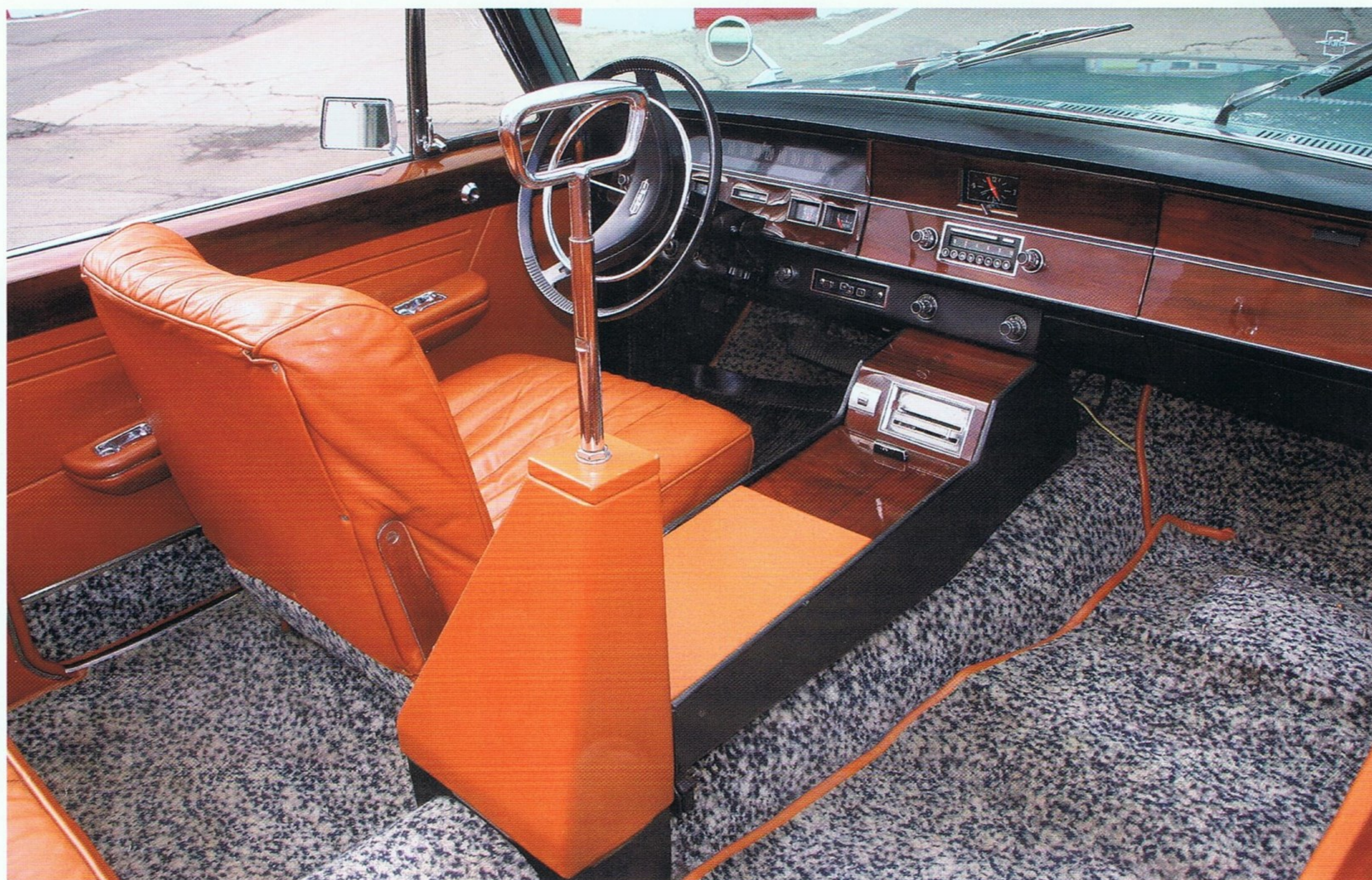
Салон парадного ЗИЛ-117В. Хорошо видна ручка на подиуме, за которую держался во время движения принимающий военный парад
