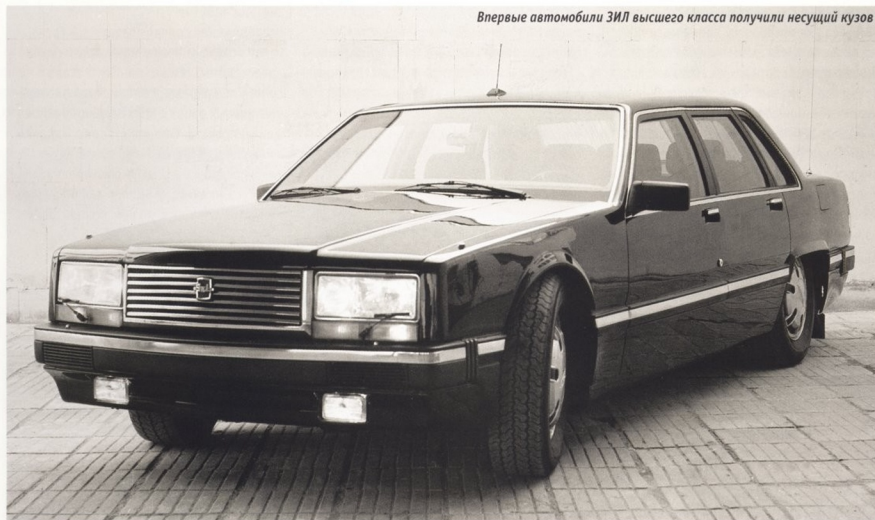
Впервые автомобили ЗИЛ высшего класса получили несущий кузов
