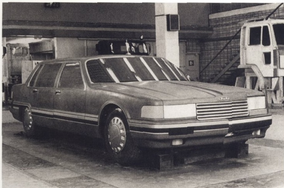
Плоский макет внешних форм ЗИЛ-4102 в натуральную величину машины
