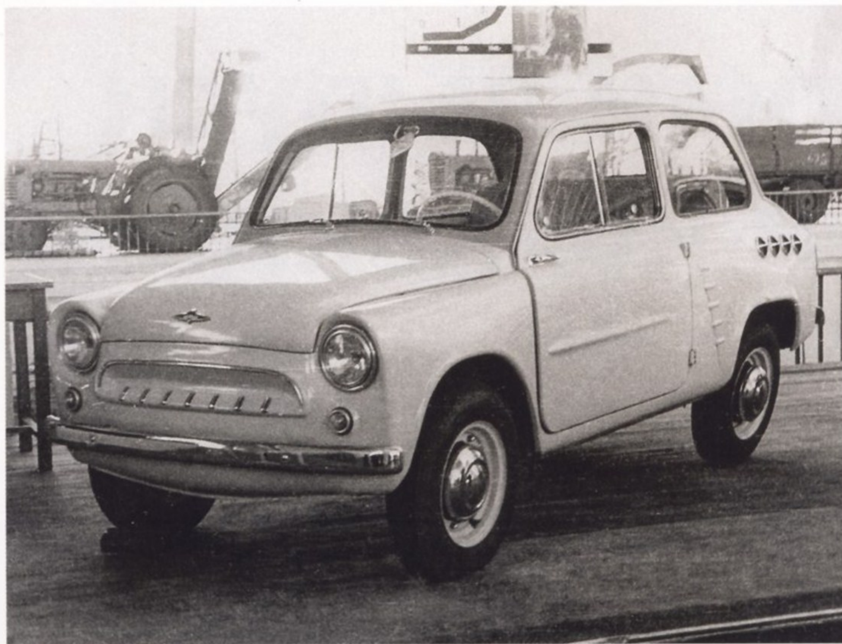
«Москвич-444», разработанный для производства на ЗАЗе. Вариант, максимально измененный по сравнению с FIAT-600
