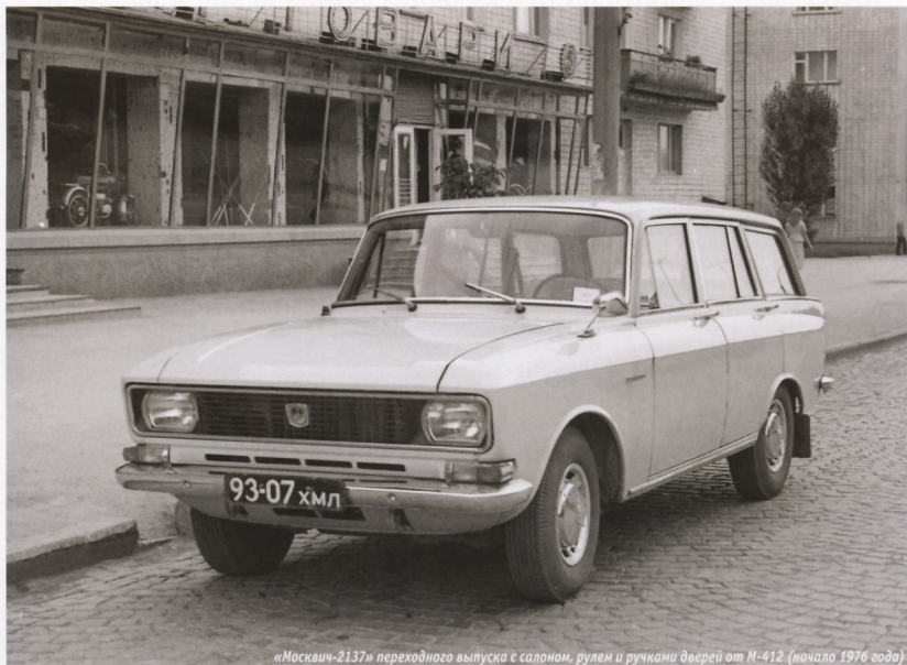
«Москвич-2137» переходного выпуска с салоном, рулем и ручками дверей от М-412 (начало 1976 года)
