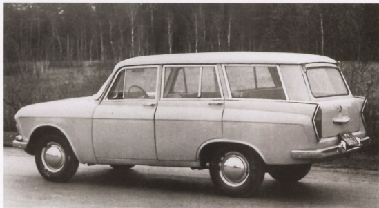
Опытный образец универсала 63У8 1961 года. Задок существенно отличается от серийных автомобилей
