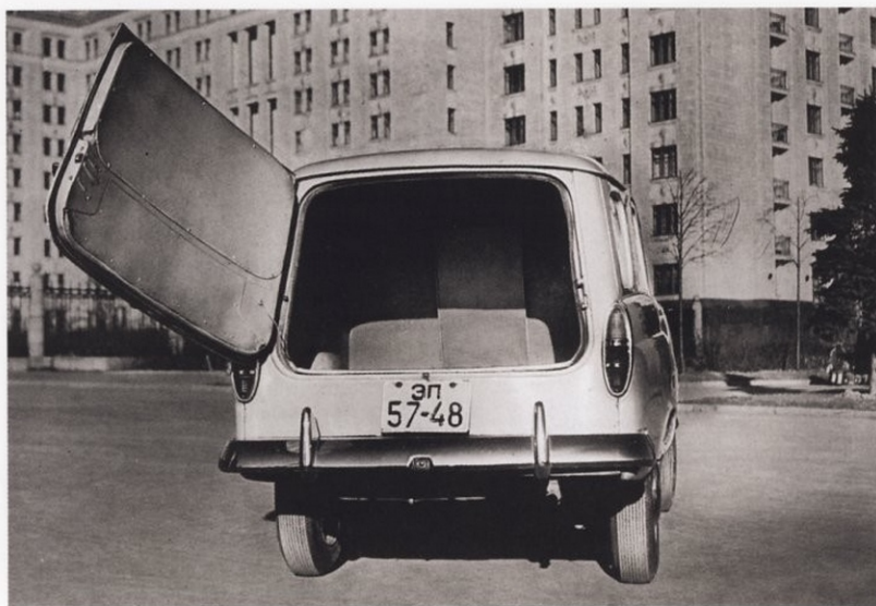
Торцевая дверь и грузовой отсек фургона «Москвич-430»
