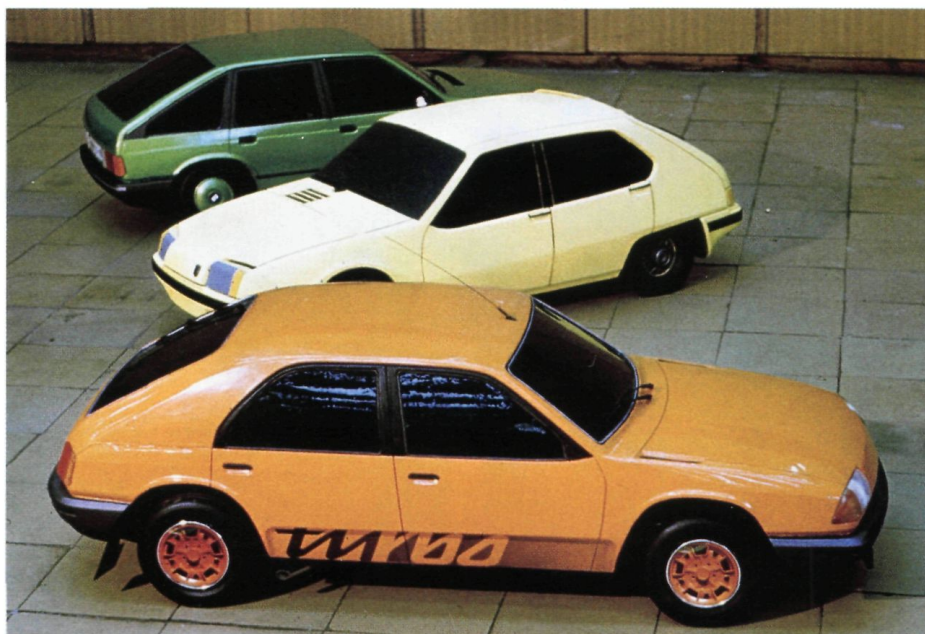
Интересно, что за С3, несмотря на сопротивление руководства, все же последовал проект С4 — на тот случай, если по какой-то причине все же удастся отказаться от копирования французского прототипа. Различные версии С4 были построены в виде макетов в масштабе 1:5
