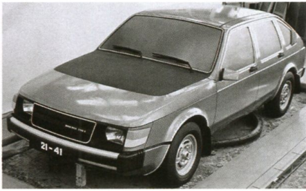
Макет СЗ, построенный в октябре 1976 года, отличался от будущего ходового образца формой фонарей указателей поворота
