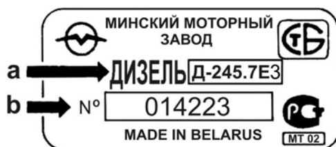
Рис. 1.3. Пример нанесение номера двигателя Д – 245.7 ЕЗ
