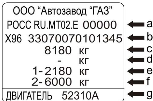
Рис. 1.4. Пример заводской таблички с паспортными данными автомобиля ГАЗ-3307: (д.б. новый рис.)
