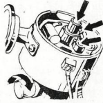
Рис. 7. Точки смазки распределителя зажигания.
