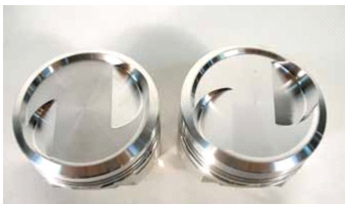
Слева поршень MМ 3200 Sport и справа MМ 2900 Sport Piston. Оба имеют глубокие выемки для клапанов.
