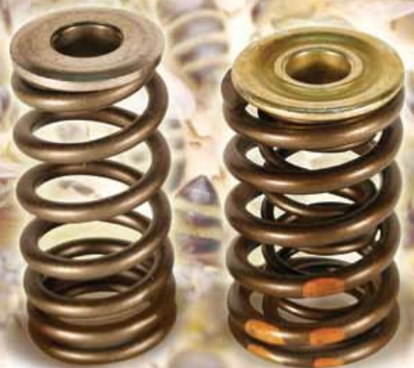
слева - пружина прогрессивная от MM "Bee Hive", справа - сток пружина
