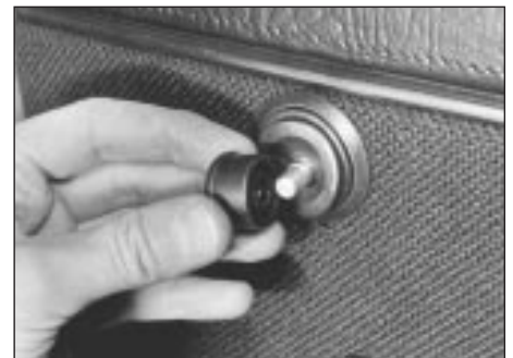
14.5 Removing door mirror adjuster knob
