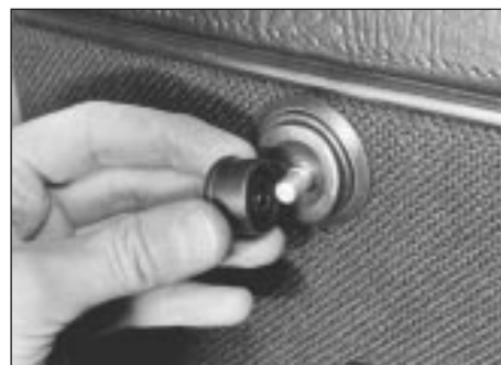
14.5 Removing door mirror adjuster knob
