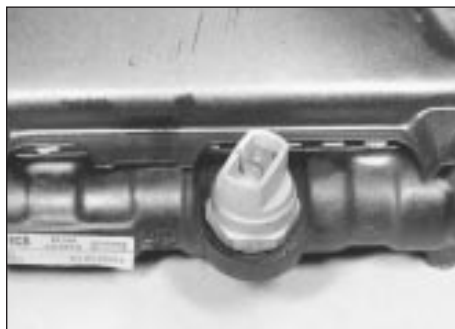
7.3 Cooling fan thermo-switch
